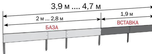
Одностороннее регулируемое по длине ограждение для грядок используется для формирования аккуратных грядок вдоль длины теплицы. Металлическое ограждение для грядки прослужат намного дольше, чем деревянное. Края его аккуратно загнуты и безопасны при сборке.
