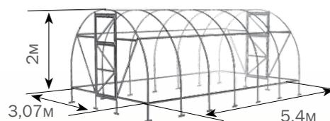
Теплица имеет два дверных проема в противоположных торцах и в каждом дверном проеме имеет дверь и форточку.
