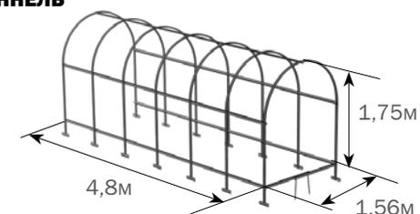
Вместо двери предусмотрен упрощенный способ открывания-закрывания торцов туннеля.
