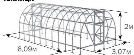
Теплица предназначена для открытых участков с сильными ветрами. Теплица имеет два дверных проема в противоположных торцах и в каждом дверном проеме имеет дверь и форточку.
