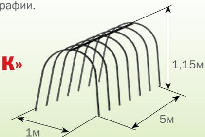
Каркас парника составляется из дуг и продольной перекладины. В конструкции парника предусмотрены надежное закрепление пленки и удобство открывания-закрывания парника с помощью свободных реек, входящих в комплект.
